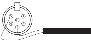
Conector DIN 45322 – Conexión de PIN3 y PIN5 a la regleta de conexión
