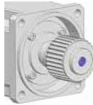
2. Spingere il disco distanziatore tramite chiave nel perno motore fino al contatto con la superficie di fondo.
