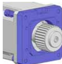
3. Desplazar el disco dentado hasta que haga contacto con la placa distanciadora sobre el gorrón de accionamiento.
