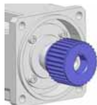
3. Desplazar el disco dentado hasta que haga contacto con la placa distanciadora sobre el gorrón de accionamiento.
