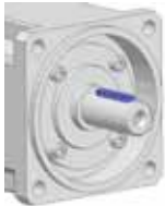
1. Montar el muelle de ajuste en el gorrón de accionamiento.
