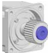
4. Poser la rondelle dans le disque denté.
