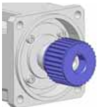
3. Spostare il disco dentato fino al contatto con il disco distanziatore sul perno motore.
