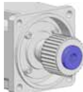
4. Scheibe in die Zahnscheibe einsetzen.
