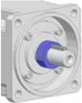
2. Pousser l'entretoise sur la clavette dans le tourillon d'entraînement jusqu'à ce qu'il entre en contact avec la surface de base.
