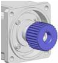
3. Pousser le disque denté jusqu'à ce qu'il entre en contact avec l'entretoise sur le tourillon d'entraînement.
