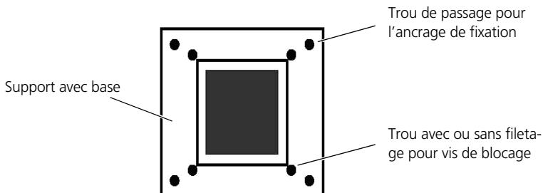
Toute irrégularité dans la construction du pied de type 1 (élément de serrage de type FVV) peut être rectifiée à l'aide des vis de blocage. Des cales protectrices placées sous les pieds permettront d'empêcher les vis de blocage de rentrer dans la base. Les cales d'ajustement assurent une meilleure stabilité de la pièce de serrage des pieds sur des sols irréguliers.
