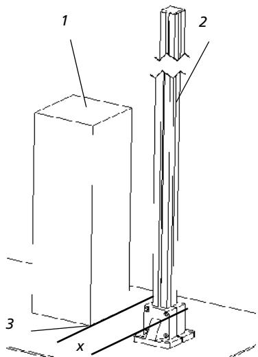
Bei der Montage eines Schutzaunes empfiehlt es sich, nach der Festlegung des Bezugspunktes, den Schutzaun zunächst einmal lose aufzustellen. Dieser ist aber gegen umfallen, mit entsprechenden Hilfsmitteln, zu sichern.
