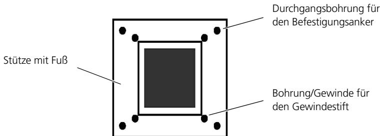
Unebenheiten lassen sich bei den Fußausführungen Type 1 (Klemmelemente vom Typ FVV) mit Hilfe von Gewindestiften ausnivellieren. Abstützbleche, die unter den Fuß geschoben werden, verhindern ein „eingraben“ der Gewindestifte in den Fußboden. Die Ausgleichbleche ermöglichen ein vollflächiges Aufliegen des Fußklemmstücks bei unebenen Untergründen.
